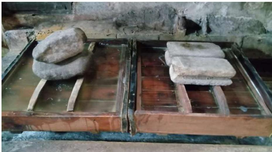
Gambar 10. Proses Press Sari Tahu Dalam Cetakan
